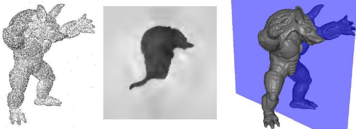
Рисунок 3.11. Точки отримані під час сканування моделі (ліворуч), відтворення Пуассона для поверхні (праворуч) та візуалізація характеристичної функції (посередині). [12]
